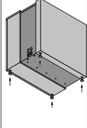
**KA-520 L / XL:** Der Luftreiniger kann stehend oder liegend verwendet werden. Auf die Unterseite müssen die mitgelieferten Filzleiter geklebt werden, um Beschädigungen am Boden zu vermeiden!
