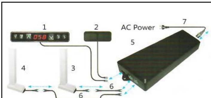
Kabel gemäß den Pfeilrichtungen verbinden
